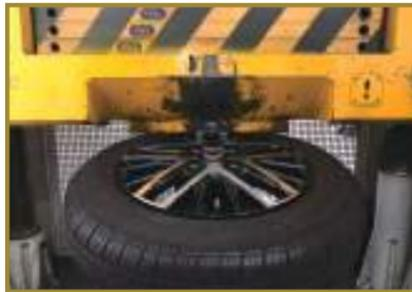
縁石等に当たり強い衝撃を受けた状態を想定した試験であり、KYOHOOは錘体重量を通常試験基準よりも重くし、高さを基準よりも更に上げてより衝撃を与える状態で試験・検査をしております。
