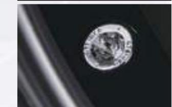
シュタイナー LSTのピアスボルトは前作の LMX/LSV に続き、シリーズ専用のピアスボルトを採用しています。細かいパーツですが金型から製造し、さらにはシュタイナーのネーミングが刻印されたオリジナルデザインとなっています。ほかでは見られない優越感が魅力で、アフターホイールならではの輝きと高級感を与えています。
