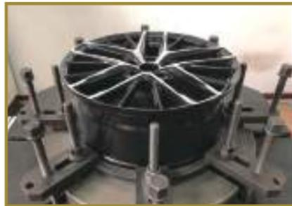
コーナリング走行を想定した耐久試験であり、KYOHOOは試験条件の20%UPの12万回転、JWL-Tは30万回転、更に試験基準よりも荷重値を上げ、より負荷をかけた状態で試験・検査をしております。
