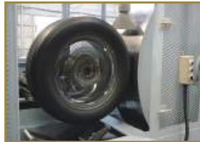
走行中での上下への負荷の耐久性を確認する為の試験であり、KYOHOOは試験条件の20%UPの60万回転、JWL-Tは120万回転、更に回転曲げ疲労試験同様に試験基準よりも荷重値を上げ、より負荷をかけた状態で試験・検査をしております。
