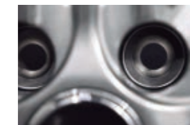
ボルト(ナット)座面形状:球面
