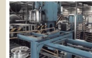
重要保安部品の一つであるアルミホイールは人の命を預かるもの。エア漏れによる重大な事故を防ぐため、厳しい条件の中で検査が行われています。ヘリウム検査は気体密度が小さいため、微細な穴まで検査することができます。
