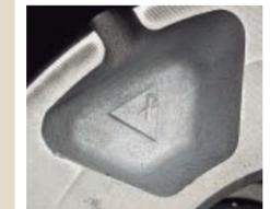
検査を行った証としてXマークを刻印します。最終の外観検査時に刻印確認は検査項目となっています。
