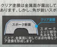
スポーク断面 クリア塗膜 スポークのエッジ部分が丸みを与えることで、金属面に対してはほぼ均等なクリア塗膜を形成します。
