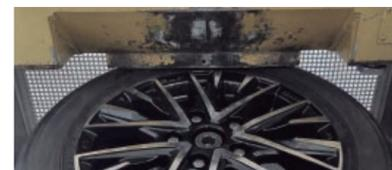
縁石等に当たり強い衝撃を受けた状態を想定した試験であり、KYOHÔは錘体重量を通常試験基準よりも重くし、高さを基準よりもさらに上げてより衝撃を与える状態で試験・検査をしています。
