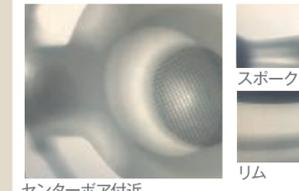
ホイールは外観での判断だけでは無く、センターボア付近、スポーク、リムの内部の状態も確認をします。X線による検査にてアルミ素材の巣や欠陥の有無を確認します。
