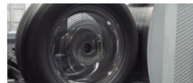
走行中での上下への負荷の耐久性を確認するための試験であり、KYOHÔは試験条件の20%UPの60万回転、JWL-Tは120万回転、さらに回転曲げ疲労試験同様に試験基準よりも荷重を上げ、より負荷をかけた状態で試験・検査をしています。
