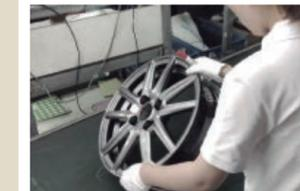
安定した品質を保つため、KYOHÔスタンプによる現地工場でのクオリティーチェックも欠かさず行い、安心・安全を徹底的に追求します。
