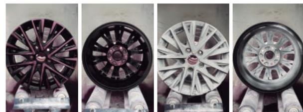
微細な亀裂までを確認するために探傷検査を行います。試験後の検体を浸透液と現像剤でクラックが無いかが慎重に確認をします。
