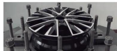
コーナリング走行を想定した耐久試験であり、KYOHÔは試験条件の20%UPの12万回転、JWL-Tは30万回転、さらに試験基準よりも荷重を上げ、より負荷をかけた状態で試験・検査をしています。
