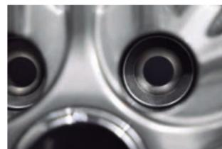
ボルト(ナット)座面形状球面
