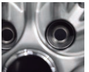
ボルト(ナット)座面形状:球面
