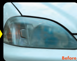
施工前はつやがなく、レンズもくすんでいる。
